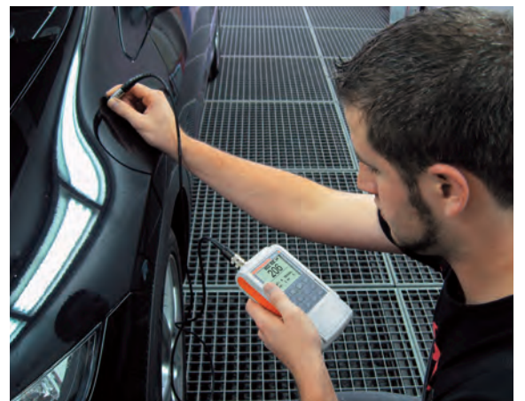
使用FD10探头测量油漆的厚度。
