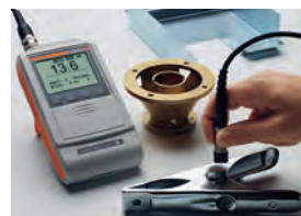
DUALSCOPE® FMP40 配合FD13探头 - 测量各种小零件
