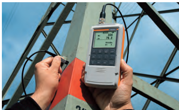
使用DUALSCOPE® FMP40以及FDX10两用探头在室外进行测量。
