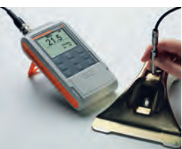
DELTA SCOPE® FMP10 – 配合FGAB1.3探头测量 铁上镀锌层。
