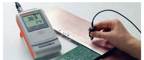
ISOSCOPE® FMP10 配合FTA3.3-Cu探头测量印刷线路板, 铜板。
