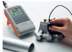
ISOSCOPE® FMP30 配合FTA3.3探头 - 测量轻合金边缘
