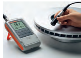
DELTASCOPE® FMP30 配合双触点探头V7FKB4 - 测量卡车刹车盘
